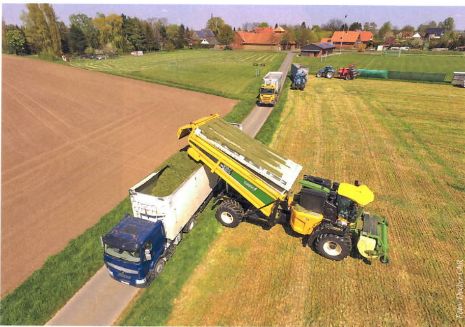
Der Bunkerhäcksler ist in der Erntezeit 22 Stunden pro Tag in Betrieb und häckselt dabei 30 bis 35 ha Silomais. Abgeladen wird am Feldrand.
